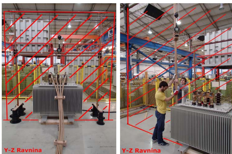
Slika 7. Mjerenje gustoće magnetskog toka referentnog TR u pokusu kratkog spoja a) NN kabeli (lijevo) b) NN kratkospojnik (desno)
